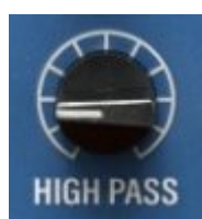
Potentiomètre de réglage de la fréquence du filtre passe-haut
