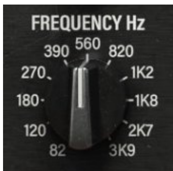
Potentiomètre de réglage de fréquence du filtre
