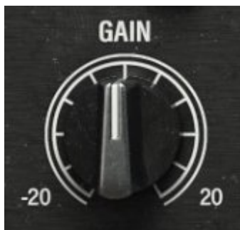
Potentiomètre de réglage de gain du filtre
